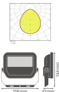
**Scheda tecnica Ledvance Proiettore LED GEN 3 Bianca 20W 2200lm 100D - 830 Luce Calda | IP65 - Simmetrico - Sostitutiva 50W**
